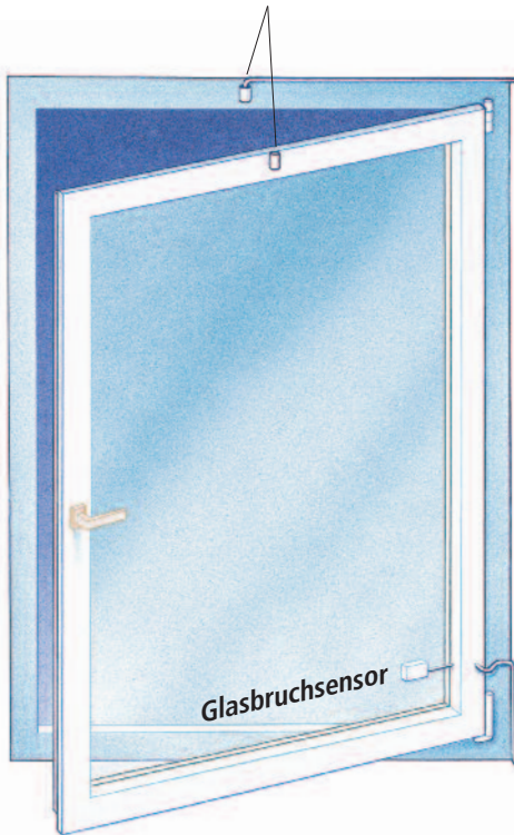
Außenhautüberwachung: elektronische Überwachung eines Fensters
